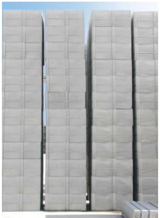
Reduzierung von Verfärbungen mit Einsatz von CEM III/A 52,5 N im Betonwarenereich.
