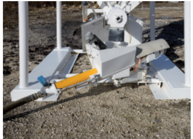
SCHWENK Füllbinder® »quadro-mat« Wasseranschluss C-Kupplung für Hydrantenanschluss, zwei Wasserzuläufe am Mischerrohr
